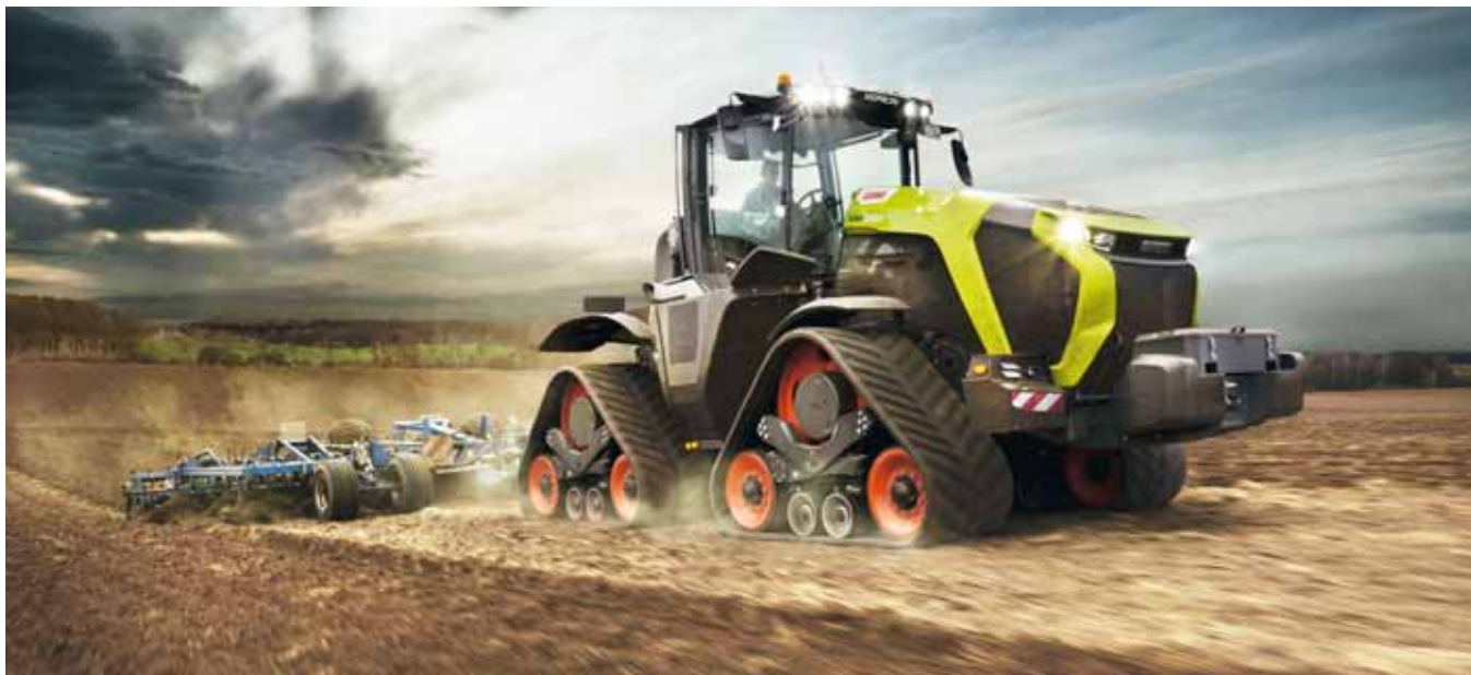
W ciągniku Claas Xerion Terra Trac serii 12 zastosowano nowy napęd gąsienicowy Fot. Claas
