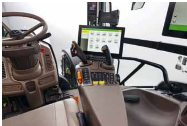
Nowy wyświetlacz G5 CommandCenter wejdzie w skład wyposażenia wszystkich 6-cylindrowych ciągników serii 6R, 7, 8 i 9 z roku modelowego 2024 Fot. John Deere
