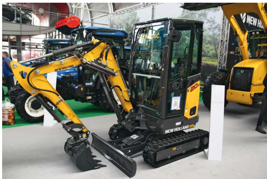
E20D to pierwsza na świecie miniparka z trzyczęściowym ramieniem kopiącym w klasie maszyn o masie 2 ton
