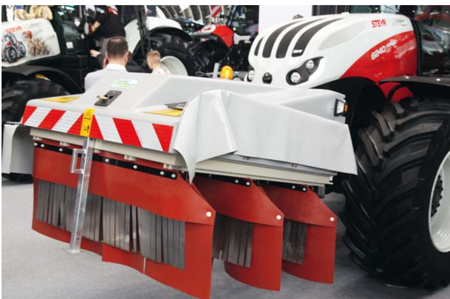
Zawieszany na ciągniku XPower XPU do elektrofizycznego zwalczania chwastów na twardych powierzchniach
