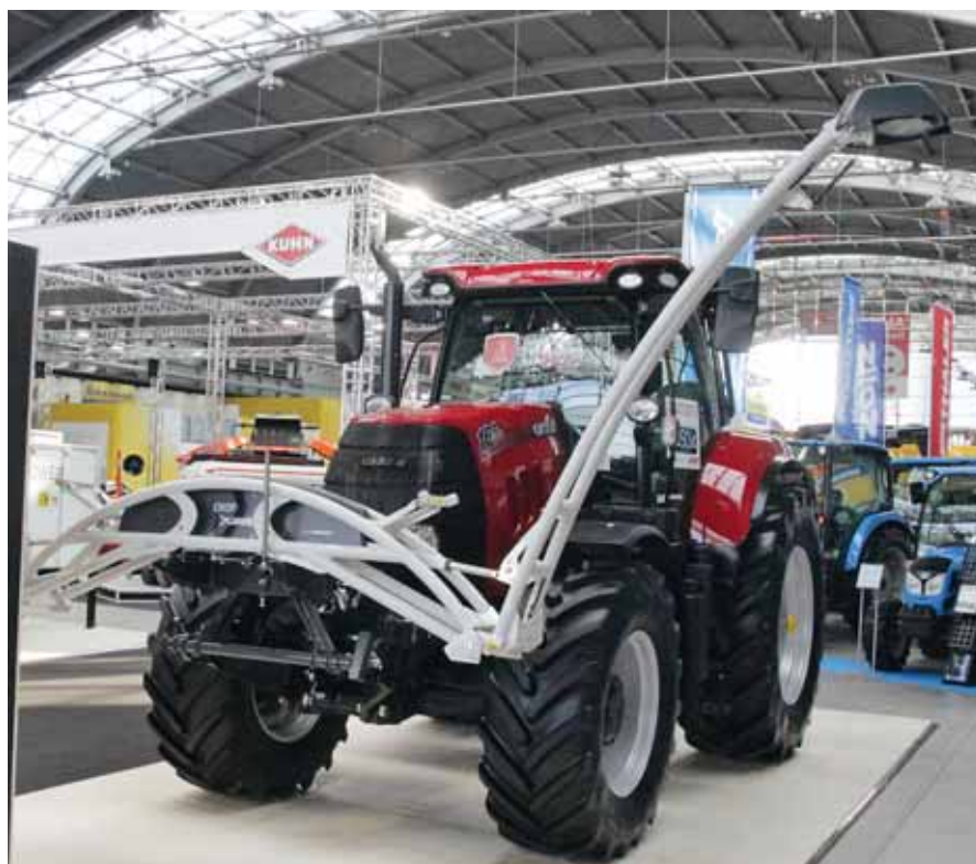
Optyczny czujnik pomiarowy CroXplorer umożliwia określenie optymalnej dawki azotu dla konkretnej populacji roślin
