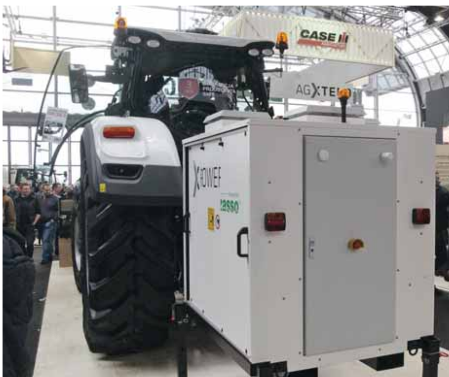
...i zawieszanego na tylnym TUZ ciągnika i napędzanego od WOM generatora wysokiego napięcia
