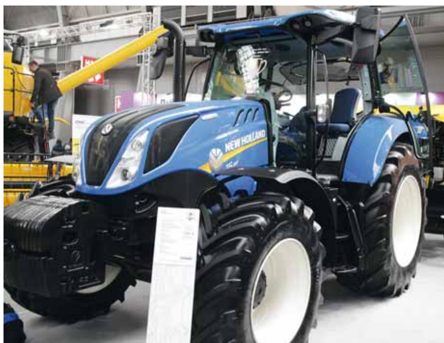
New Holland T.160 – jedyny obecnie ciągnik z silnikiem 6-cylindrowym w segmencie mocy 100–150 KM
