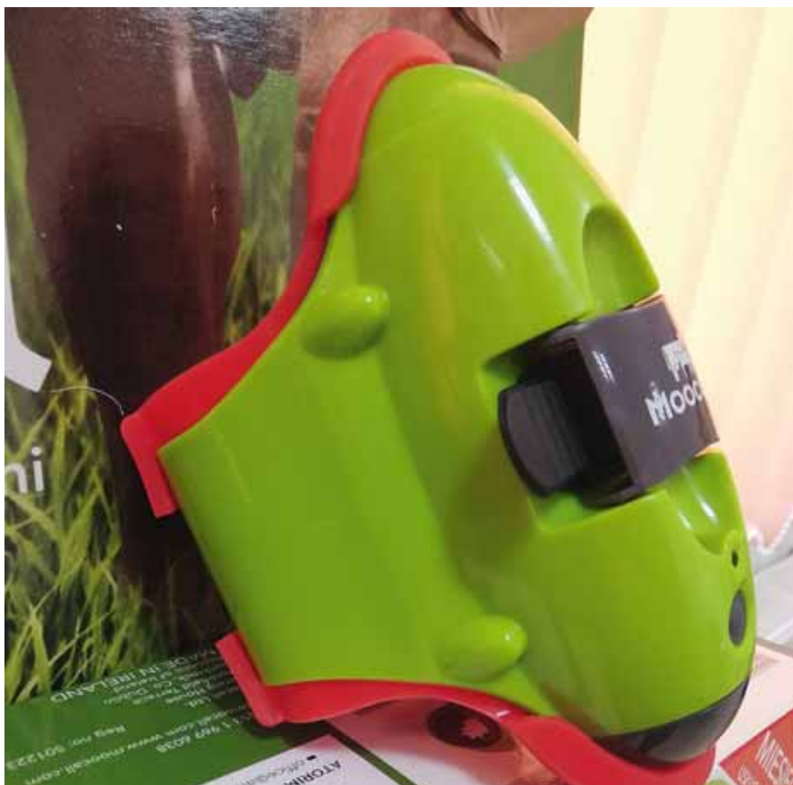
Zakładany na ogon ciężarnej krowy czujnik wycielenia Moocall informuje hodowcę o jego rozpoczęciu z jednogodzinnym wyprzedzeniem
