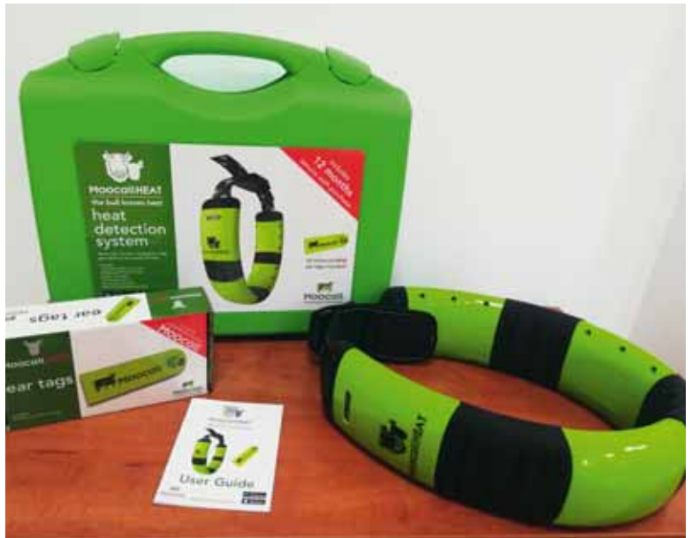
W walizce wrywacza rui Mocal Heat znajduje się obroża dla byka, kolczyki z czipem dla krów, ładowarka sieciowa oraz instrukcja obsługi
