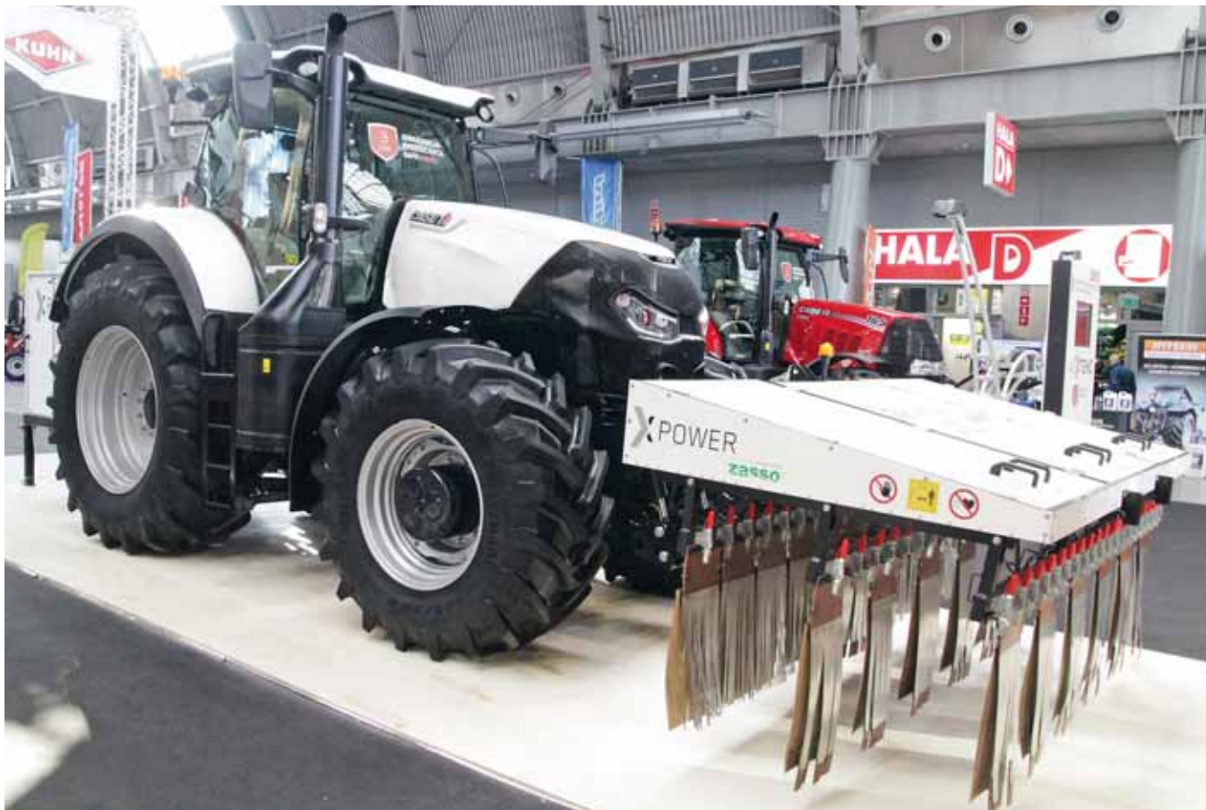
System elektrofizycznego niszczenia chwastów XPower składa się z zawieszanego czołowo na ciągniku zestawu aplikatorów...
